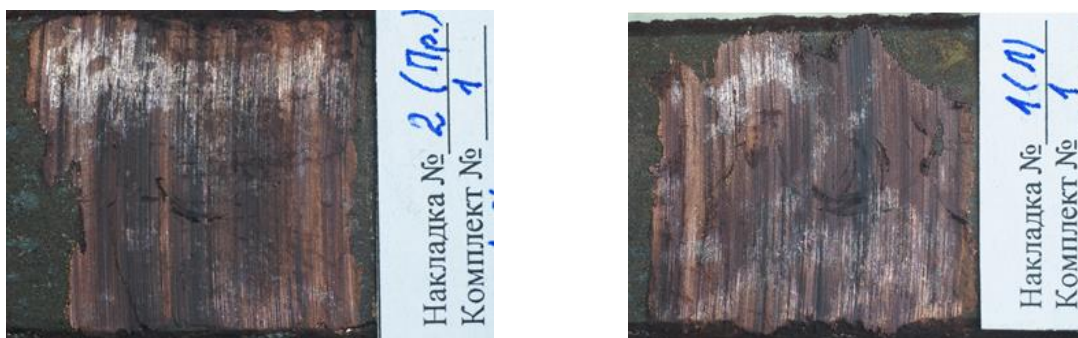
Рисунок 5 – Стан поверхні контактних вставок після 50 тис. проходів
