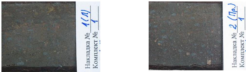
Рисунок 3 – Стан поверхні контактних вставок перед початком випробувань
