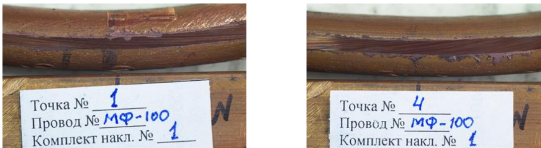
Рисунок 4 – Стан поверхні контактних проводів після 50 тис. проходів
