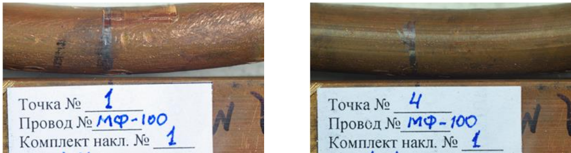
Рисунок 2 – Стан поверхні контактних проводів перед початком випробувань
