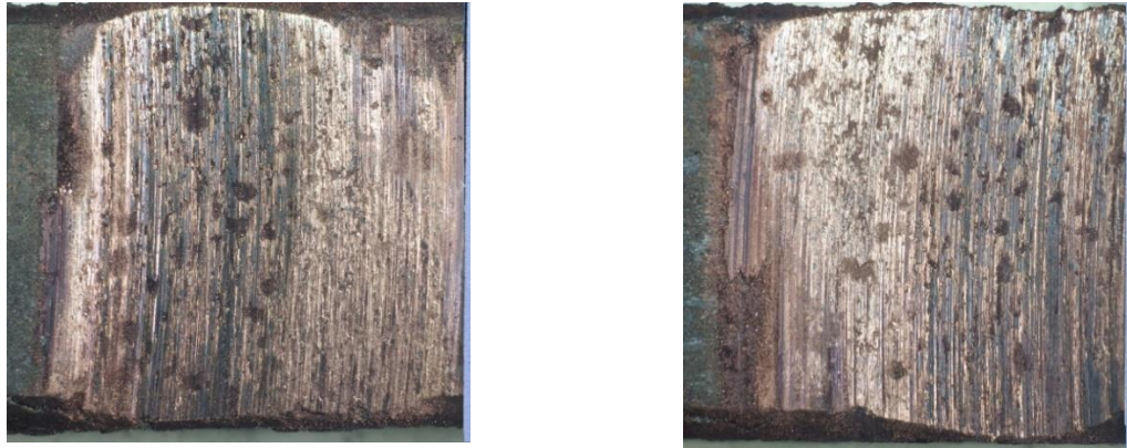
Рисунок 7 – Стан поверхні вставки після проведення випробувань
