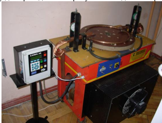
Рисунок 1 – Стенд для випробування контактної провуду та вставок струмоприймачів електрорухомого складу
