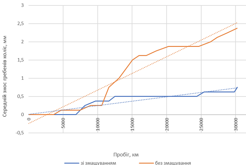
Рисунок 4 – Середній знос по внутрішнім колесам №№ 5 і 6 електровоза ВЛ11/6 (лівим і правим – всього по 4 колесам), що не переточувалися за увесь період випробувань
