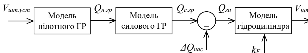
Рис. 2. Структурна схема моделі об'єкта управління
