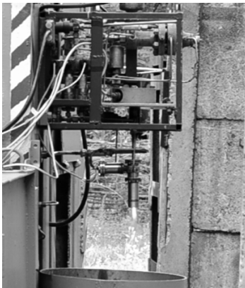
Рис. 2. Робота гібридного газогенератора монопаливного рідинного двигуна
