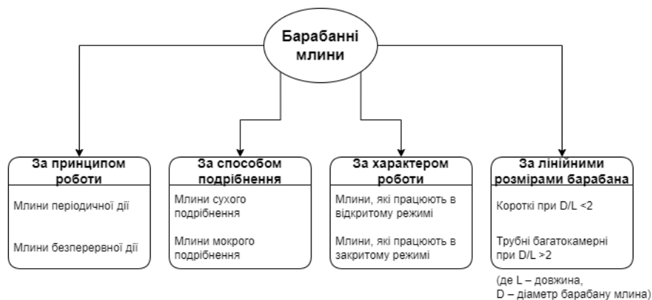
Рис. 1. Можливі класифікації барабанних млинів
