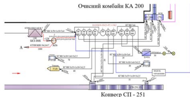
Рис. 2. Схема підключення споживачів до КТПВ збирного штреху 962 лави
