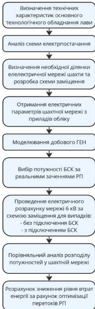
Рис. 1. Алгоритм моделювання оптимальних перетоків РП у підземних шахтних мережах
