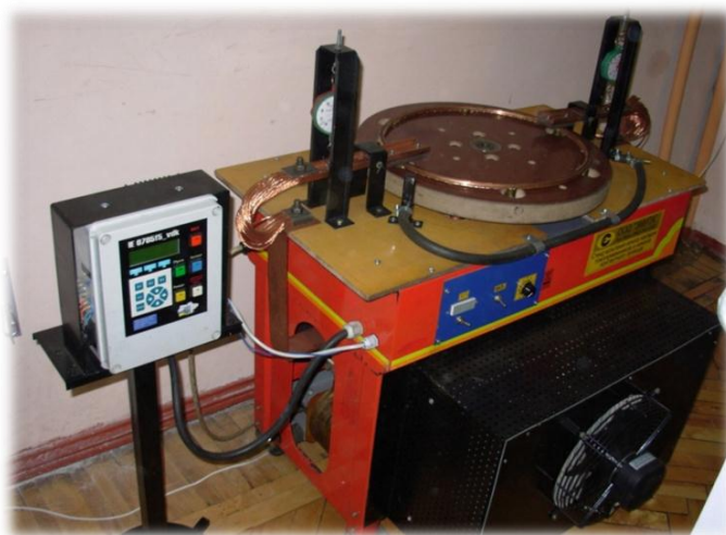
Рис. 1. Загальний вигляд стенду з дослідження зносу контактної провуду.
