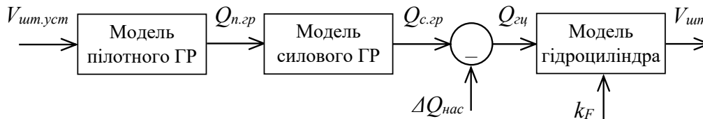
Рис. 2. Структурна схема моделі об'єкта управління
