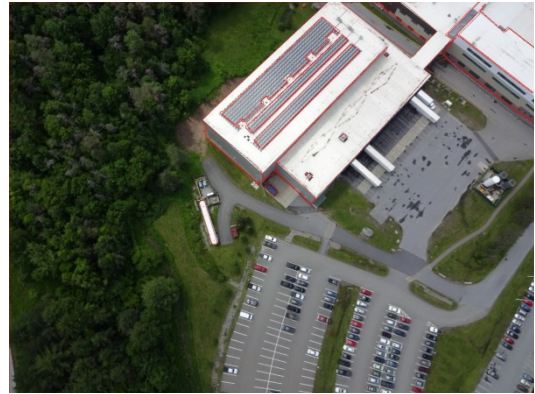
Рис. 6. Результат неймережевого виділення об'єктів будови на БПЛА зображенні
