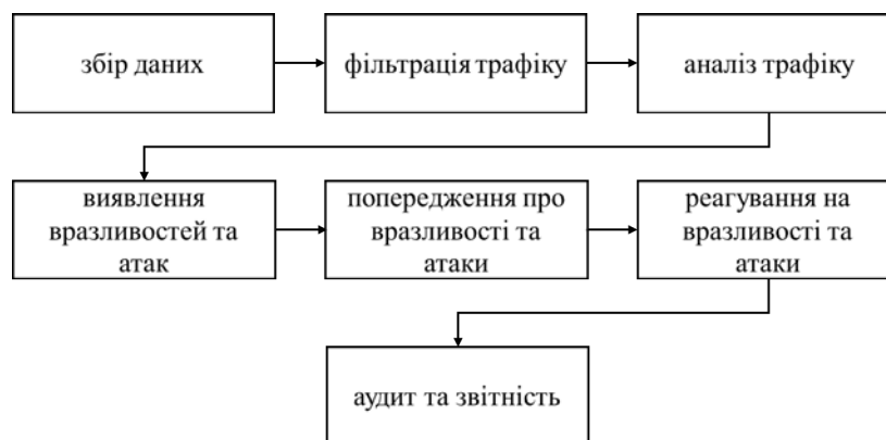
Рис. 1. Алгоритм аналізу мережевого трафіку та виявлення вразливостей/атак
