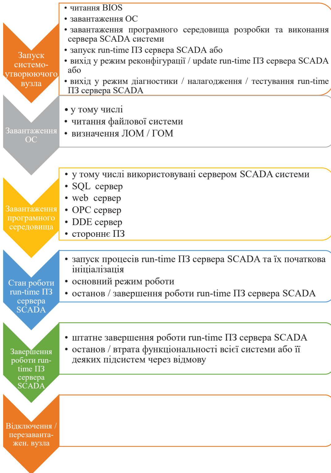
Рис. 2. Діаграма станів системоутворюючого вузла сервера SCADA
