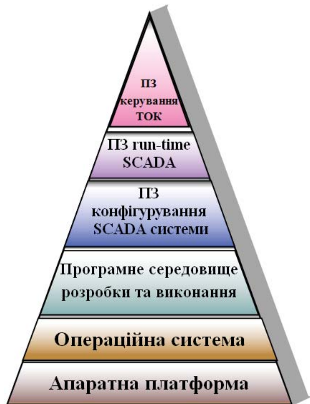
Рис. 1. Діаграма рівнів ієрархії середовища розробки та виконання SCADA системи
