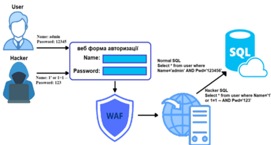
Рис. 1. Схема основних принципів та процесів атаки SQL Injection
