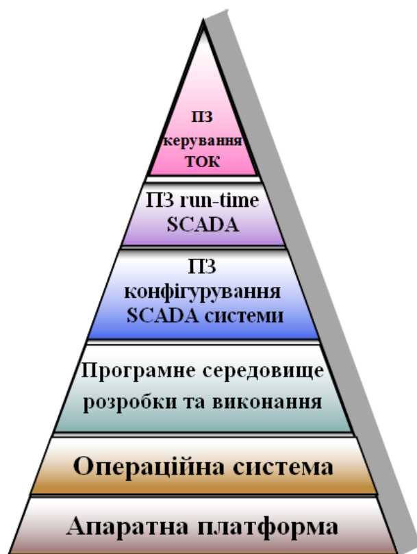
Рис. 1. Діаграма рівнів ієрархії середовища розробки та виконання SCADA системи
