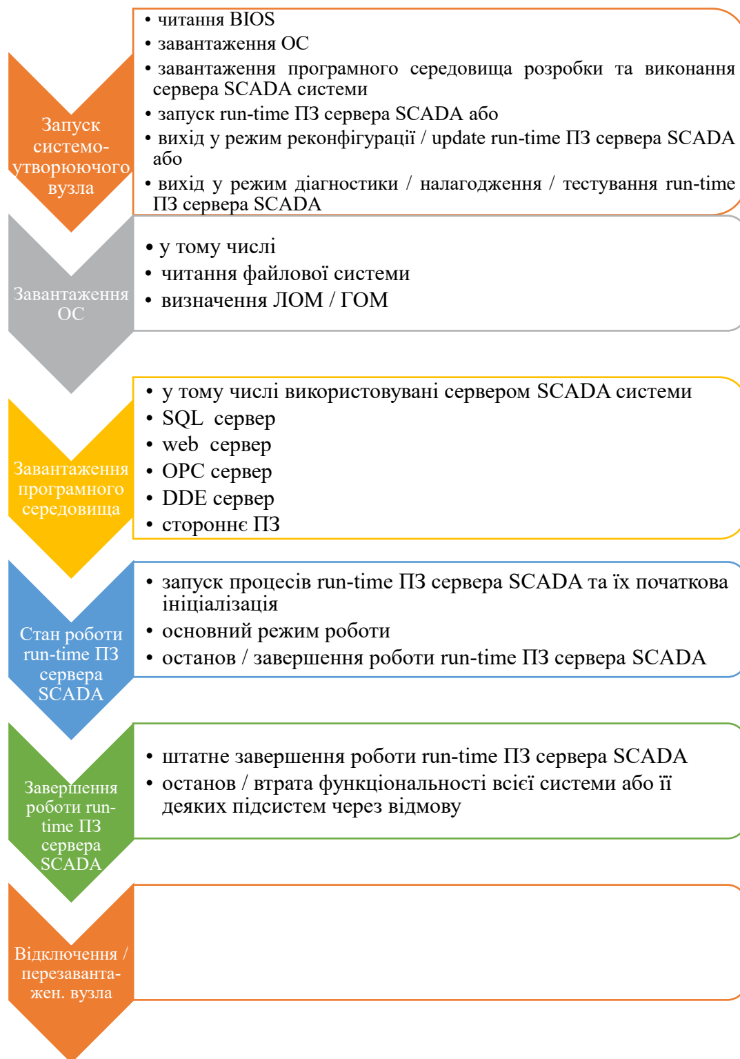
Рис. 2. Діаграма станів системоутворюючого вузла сервера SCADA
