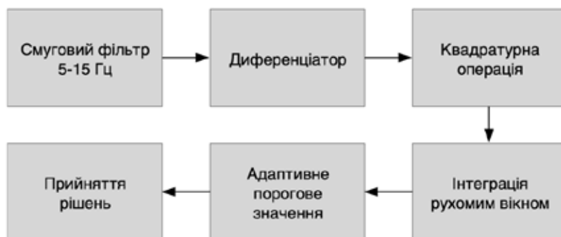
Рис. 1. Структурна схема Pan Tompkins алгоритму пошуку R-зубців
