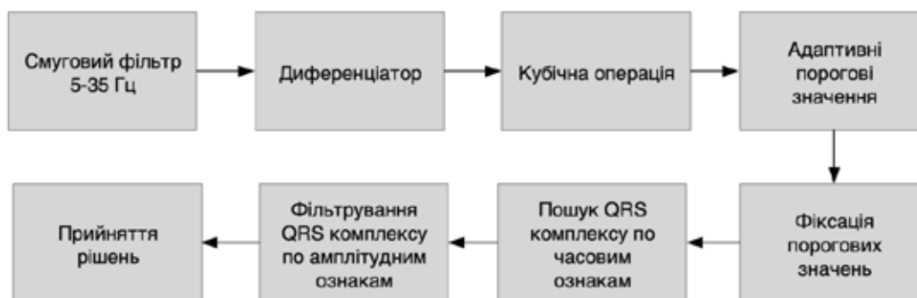
Рис. 2. Структурна схема розробленого алгоритму пошуку R-зубців
